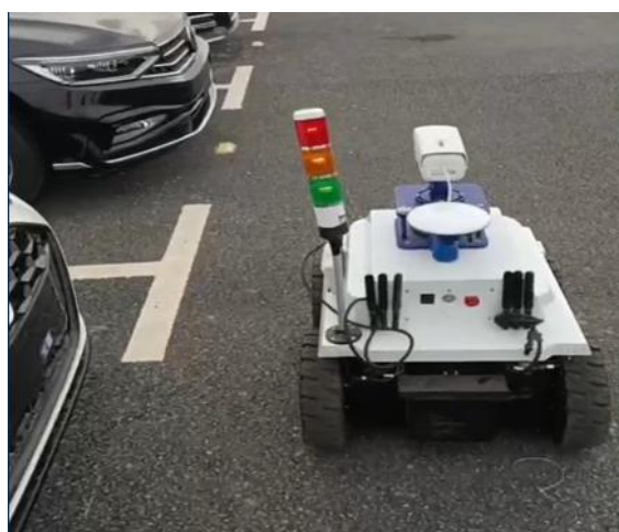
图 14-7 库区巡检机器人
